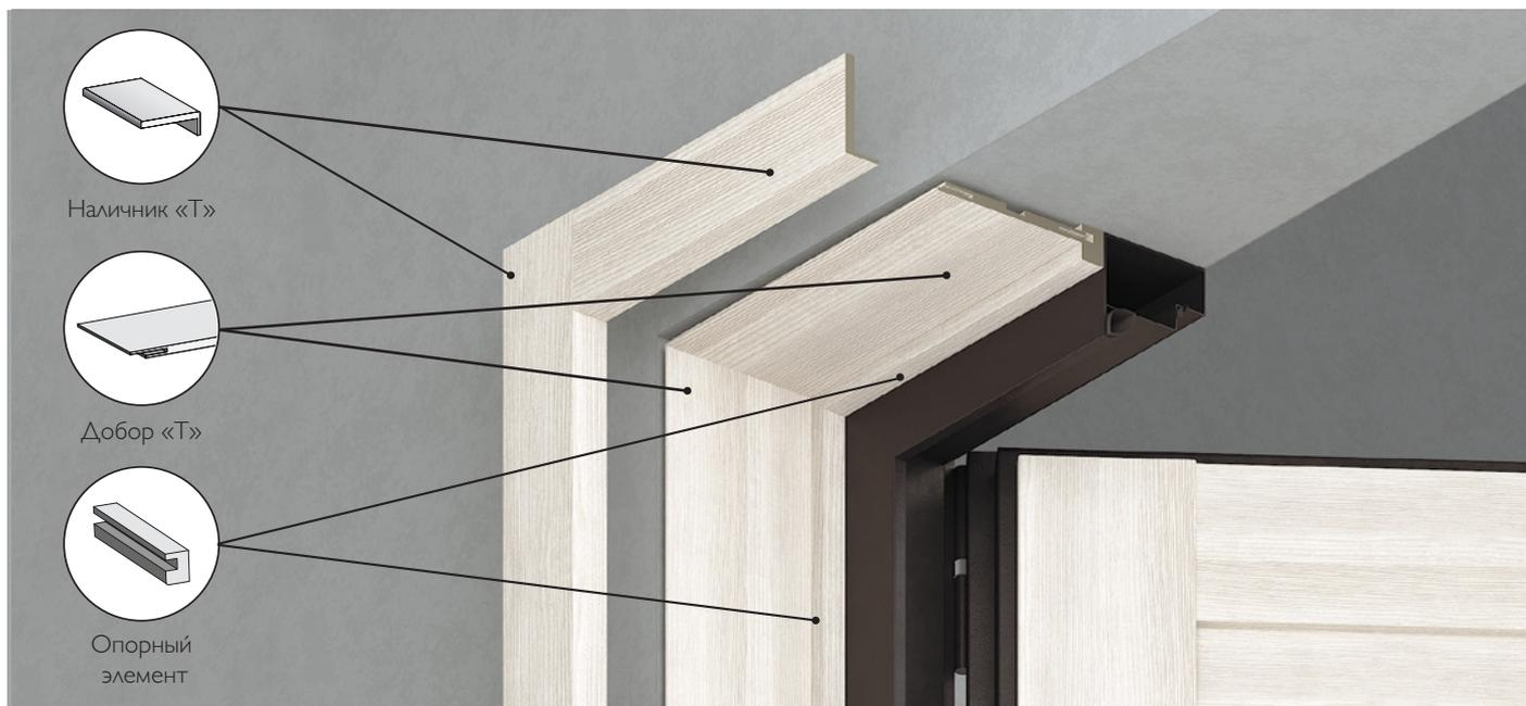
СХЕМА СОЕДИНЕНИЯ ДОБОРОВ С ИСПОЛЬЗОВАНИЕМ ШПОНКИ
